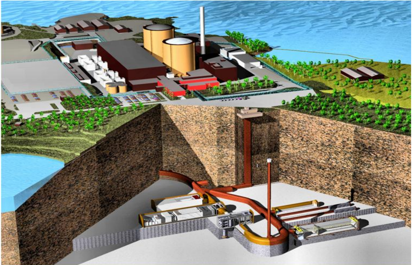
Схематическое строение хранилища РАО и его расширение на АЭС «Ловиза»
